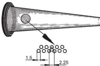
Fig. 4. Filter element.
